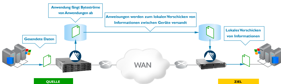
Network Memorys Byte-Ebene-Deduplizierung in Echtzeit verhindert das mehrmalige Senden gleicher Daten über das WAN.
